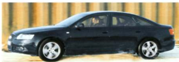
Frontantrieb. Wenig Traktion bei losem Untergrund
