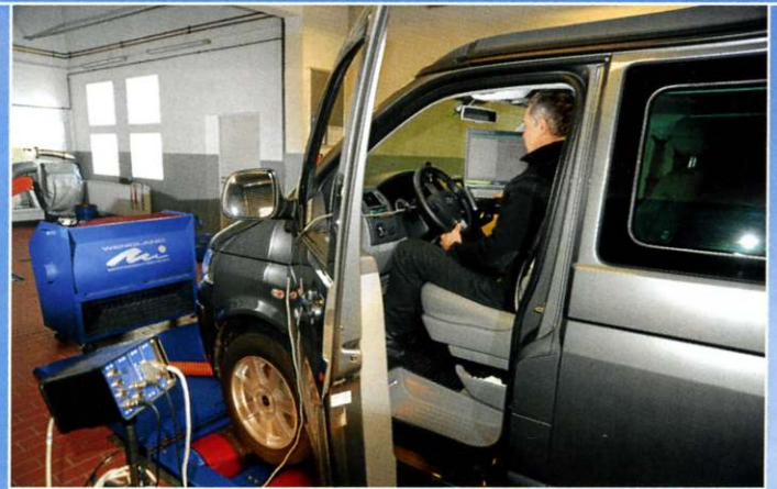
Bei Wendland werden auf dem hauseigenen Rollenprüfstand alle Fahrzeuge abgestimmt, am Ende wird ein Leistungsdiagramm erstellt.
