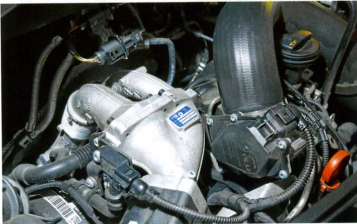
Kraft der zwei Herzen. Das Bi-Turbosystem im VW T5 schafft mit gleich zwei Turboladern frühen Drehmomenteinsatz bei guter Drehfreude.
