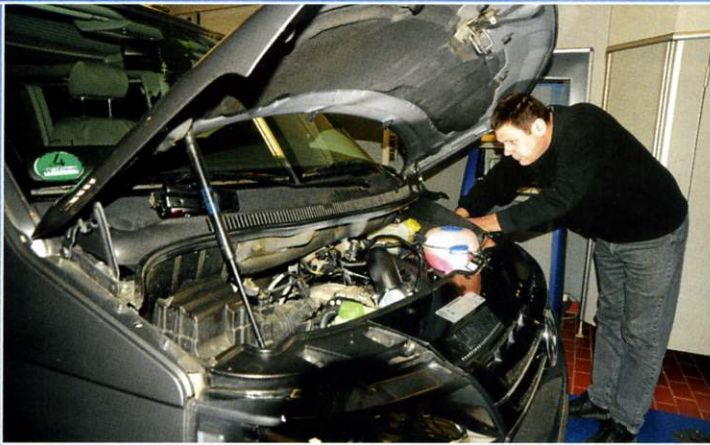
Zur Leistungssteigerung am soliden 2.0 Bi-Turbodiesel im California muss das Motorsteuergerät ausgebaut und neu programmiert werden.
