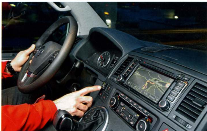
Taste mit Spareffekt. Wer will, kann beim B&B-Multivan auch während der Fahrt auf den ökonomischeren Gasantrieb umschalten.
