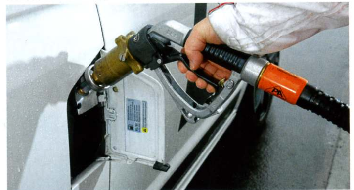
Gas und Super. Unter der Tankklappe des B&B-Multivans finden sich Kraftstoffstutzen und der Anschluss für den 65-Liter-Flüssiggastank.
