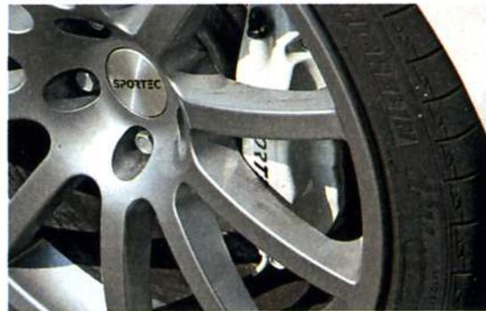
Für die Vorderachse bietet Sportec eine Bremsanlage ähnlich der des Porsche 993 Turbo an (3094 Euro), die Scheiben sind dann gelocht
