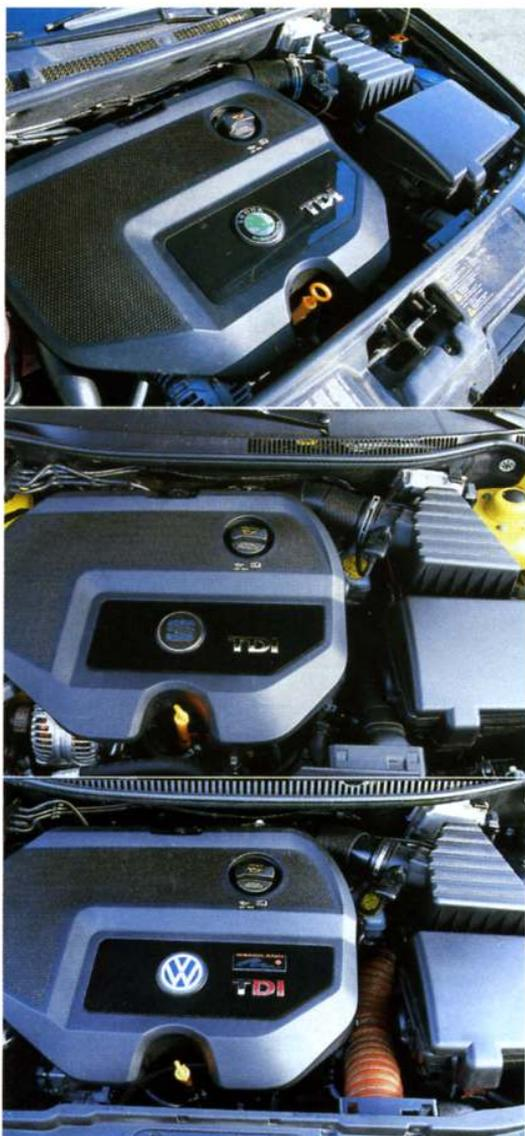
**Einheitsbrei:** Ein Aggregat, dreimal Langeweile – nichts zu sehen außer schwarzem Plastik. Hopa setzt auf ein Zusatzsteuergerät, JE Design modifiziert das vorhandene. Der orange-farbene Schlauch im Polo-Motorraum verrät das getunte Ansaugsystem
