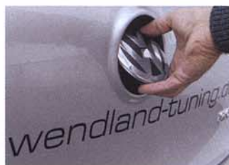
Originell und zweckmässig: im Logo integrierte Entriegelung.
