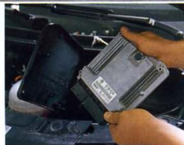
Das Steuergerät findet sich im T5 in einem geschützten Gehäuse unter der Batterie
