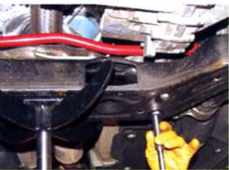
Zur Stabimontage wird der Hilfsrahmen abgeschraubt
