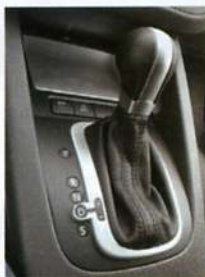
Das DSG revolutioniert das Schalten: Die Hände bleiben stets am Lenker.
