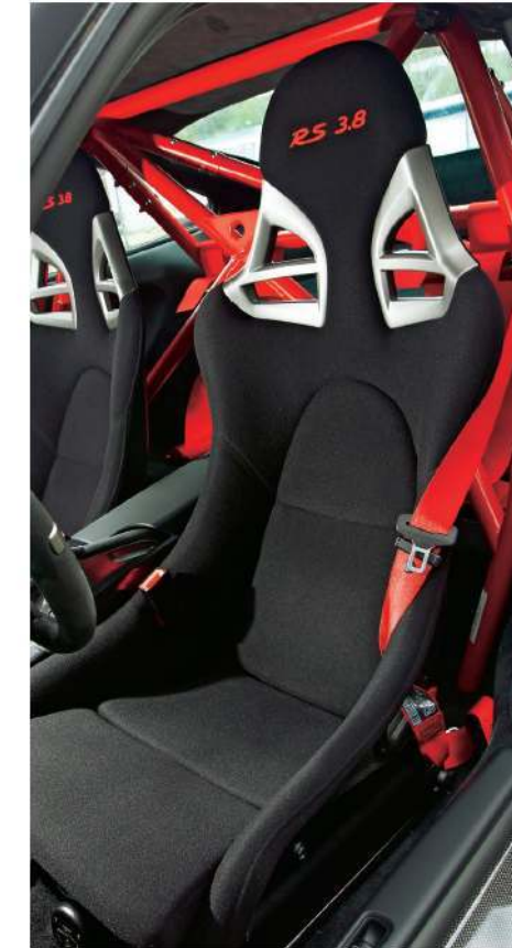
Optisch verraten weder die mattschwarze Karosserie noch die Serienschalensitze mit eingesticktem RS 3.8-Logo den Motorumbau des Wendland-Porsche 997 GT3 WRS 510. Eine vier Kilo leichte Carbon-Fronthaube (Serie: zirka 10 kg) drückt das Fahrzeuggewicht vollgetankt unter 1400 kg (Preis: 2500 Euro)
