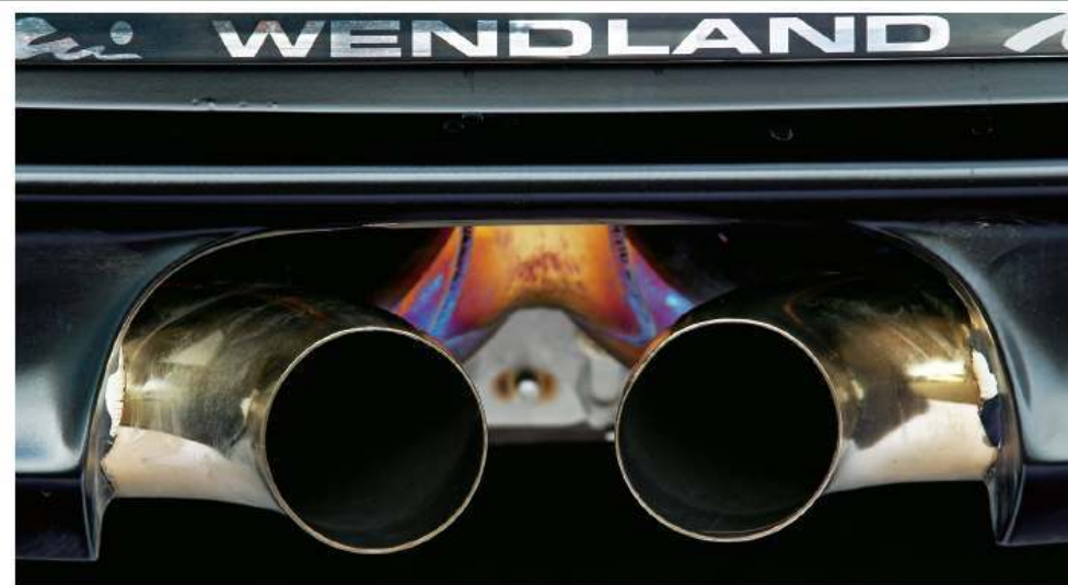
Edelstahl statt Titan: Anders als beim Serien-GT3 RS setzt Wendland beim 997 GT3 WRS 510 auf eine Komplettabgasanlage aus Edelstahl (8000 Euro). Mit Fächerkrümmer ähnelt der Klang den Rennwagen aus dem Carrera Cup
